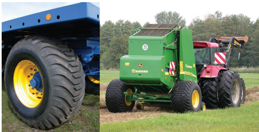
24 pav. Žemo slėgio padangos ir sudvejinti ratai gerokai sumažina technikos slėgį į dirvos paviršių
