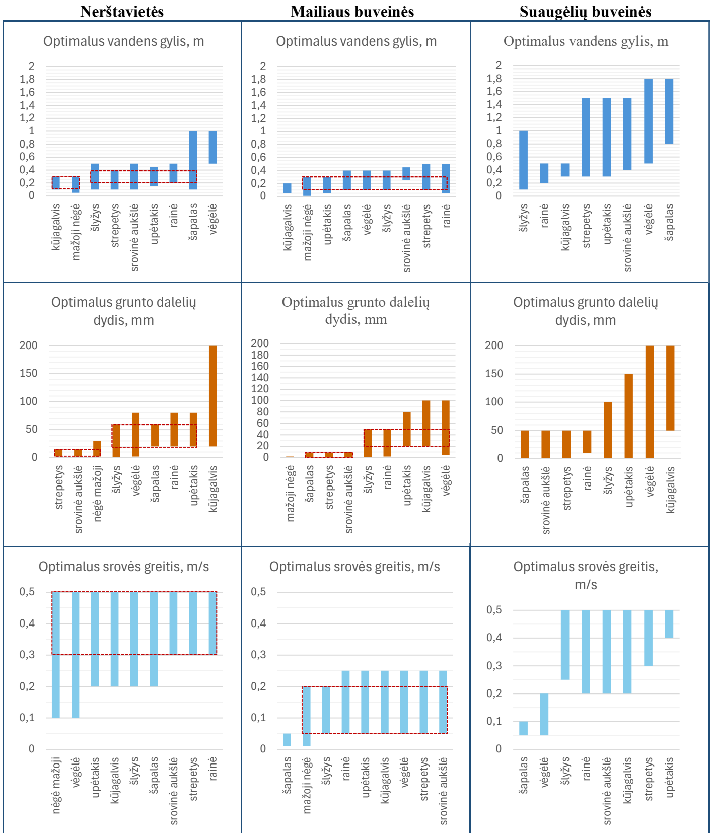
2 pav. Upių VT morfologijos atkūrimo kontekste aktualių litofilinių žuvų rūšių skirtingų buveinių pagrindiniai parametrai (pagal Madora, A. ir Saly, P. (2025), Stoffers, T. ir kt. (2021) ir kt.). Pateikiami optimalių buveinių parametrai, tačiau tolerancijos ribos gali būti didesnės. Punktyru apvesti parametru diapazonai, palankūs kelioms rūšims.
